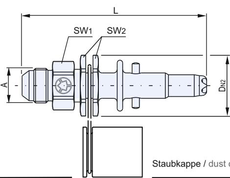
Stecknippel mit rückflussreduzierendem Rückschlagventil
