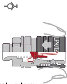
-0- Verschlusskupplung = Kupplung mit Ventil
