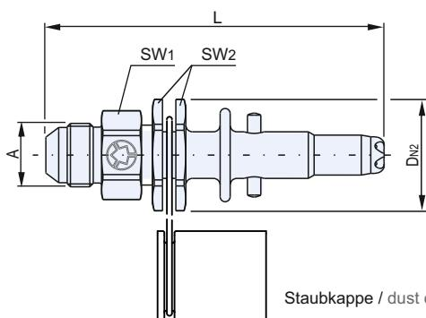
Stecknippel mit rückflussreduzierendem Rückschlagventil
