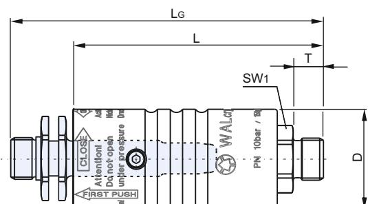
Verschlusskupplung / Self sealing coupling
