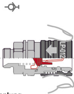
Verschlusskupplung = Kupplung mit Ventil
